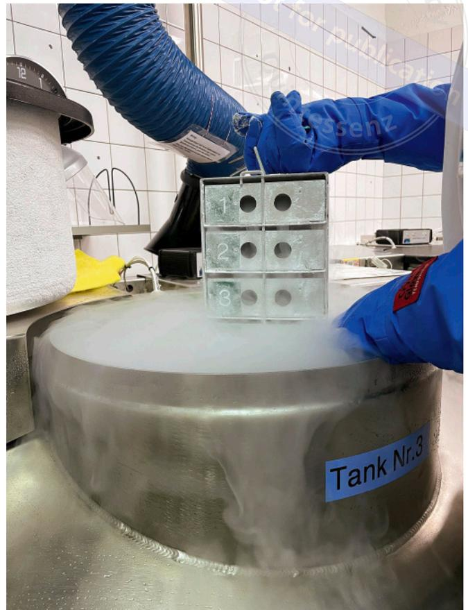
**Abb. 1** Einer von zahlreichen Stickstofftanks (-196 °C) für verschiedene Gewebe und Zellen am Universitätsspital Basel.
